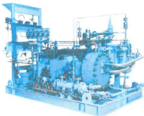
Slika 14. Kompresorska stanica s membranskim kompresorom
